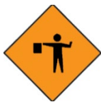
Aproximação de controlador de trânsito
